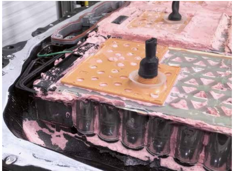
Verklebte Zellen einer Tesla-Model-Y-Traktionsbatterie
